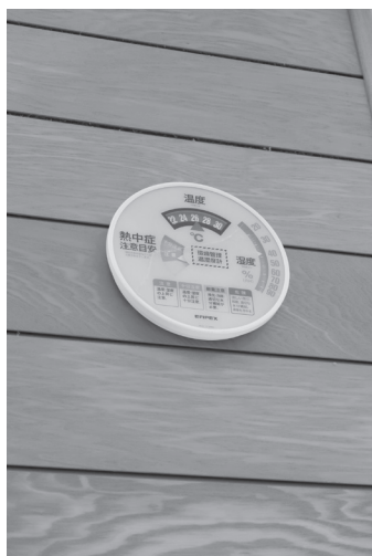
写真6 設置された温度湿度計
